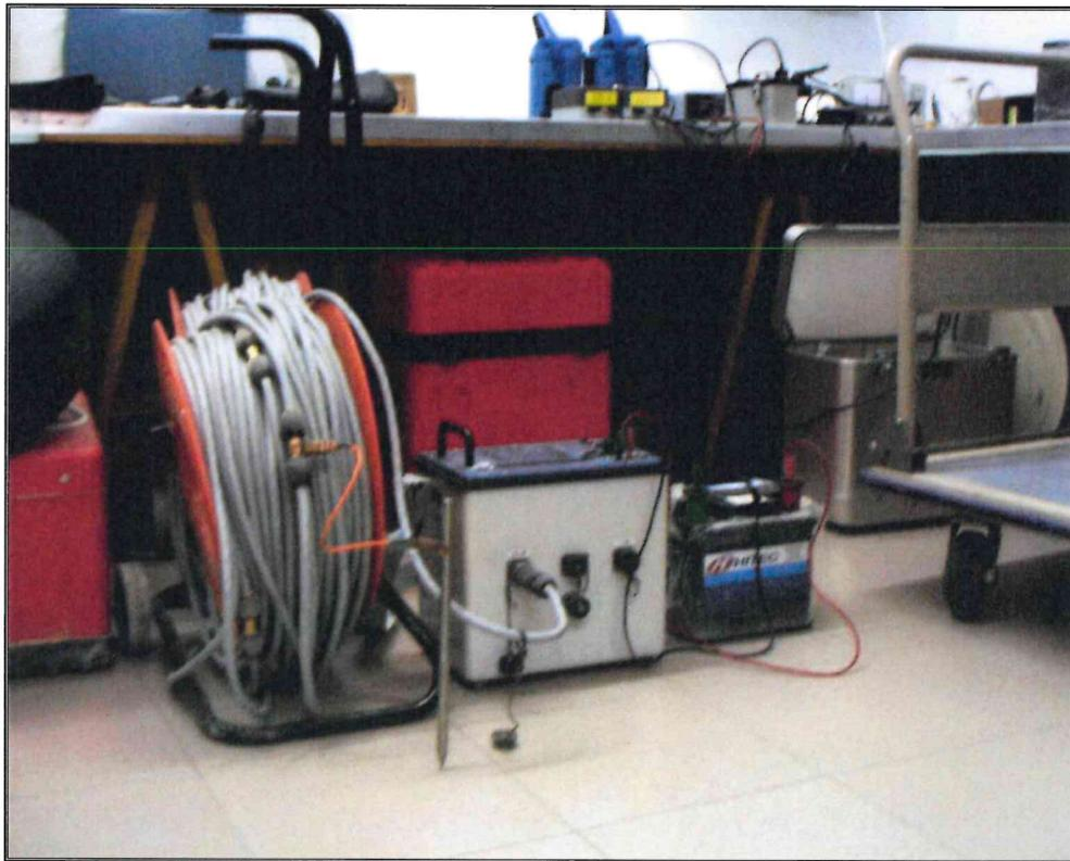
Syscal Pro con cavi multicanale, picchetti e batteria esterna.
